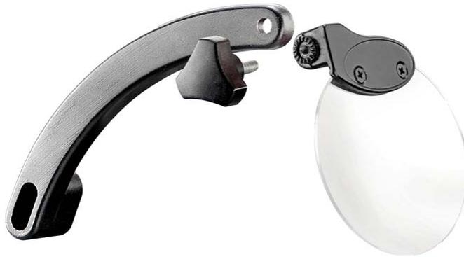
Die Schraube M6 x 30 (Sechskant) durch die Bohrung im Haltebügel in die Schutzhaube schrauben und festziehen. Mit Hilfe dieser Schraube und der länglichen Bohrung am Haltebügel kann die Position des Augenschutzes / Sichtschutzes von jedem Benutzer individuell eingestellt werden.
